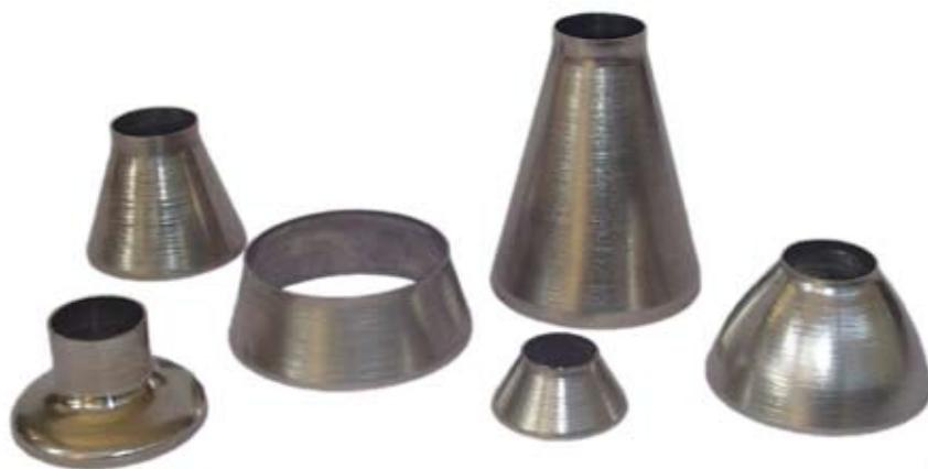
Realizzate al 100% in aisi 304 con il metodo della tornitura su lastra. Questo assicura la possibilita' di ottenere qualsiasi tipo di cono a disegno a costi molto competitivi. Inoltre si possono ottenere spessori costanti da 0,8mm a 3mm su tutto il profilo conico.
