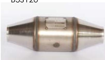
Catalizzatori a celle aperte per motori euro 2 ad una sonda lambda. Sostituiti agli originali ceramici consentono di recuperare il 5% delle prestazioni (coppia e potenza) sui valori originali con catalizzatore ceramico, senza la necessità di rimappare la centralina. La particolare conformazione con cono lungo verso il motore e cono corto verso lo scarico favorisce il flusso e contribuisce ad una migliore prestazione.
