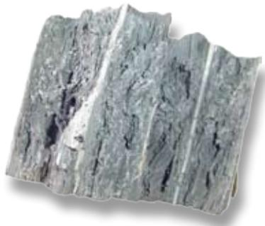
**Fig.4** - Sono evidenti le deformazioni dei canali dovute a locali accumuli di calore generati da occlusioni ricidive.
