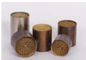
Minicatalizzatori in spire di acciaio saldobrasate, intubati in involucri di acciaio inox aisi 304. Adatti come motocat e in generale per piccoli motori a benzina (motoseghe, tagliaerba) o come emulatori per sonda lambda e starter precat. L'impregnazione e la carica sono su specifica del cliente.
