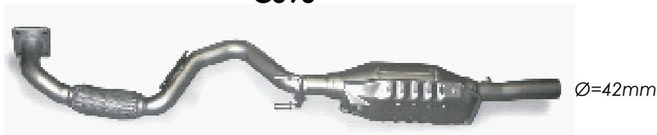
una sola sonda prima del catalizzatore
